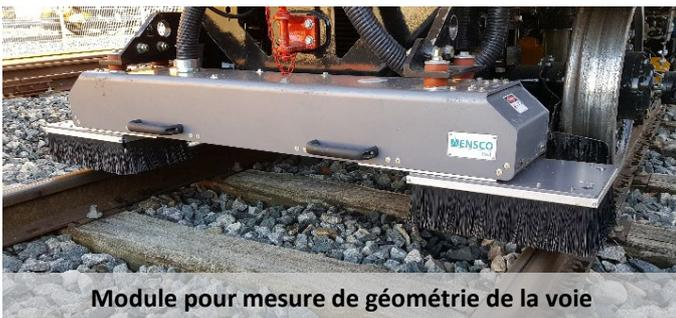
Module pour mesure de géométrie de la voie
