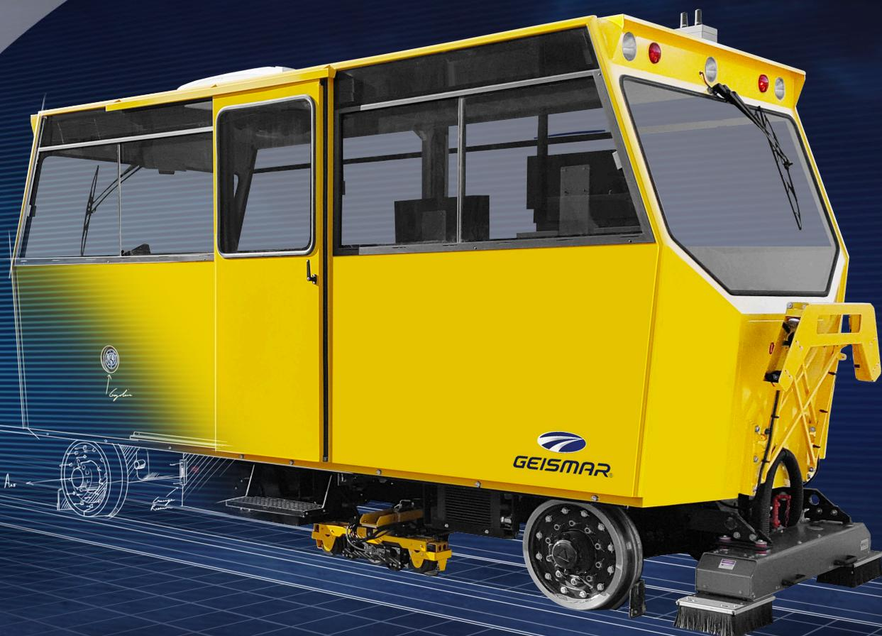
*Mesure rapide et automatique de la géométrie des voies
