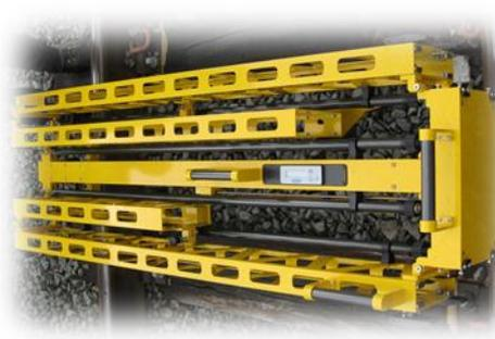
O Topaz tem **5 m de comprimento**, isto proporciona uma corda realista para medir os alinhamentos verticais e horizontais.
