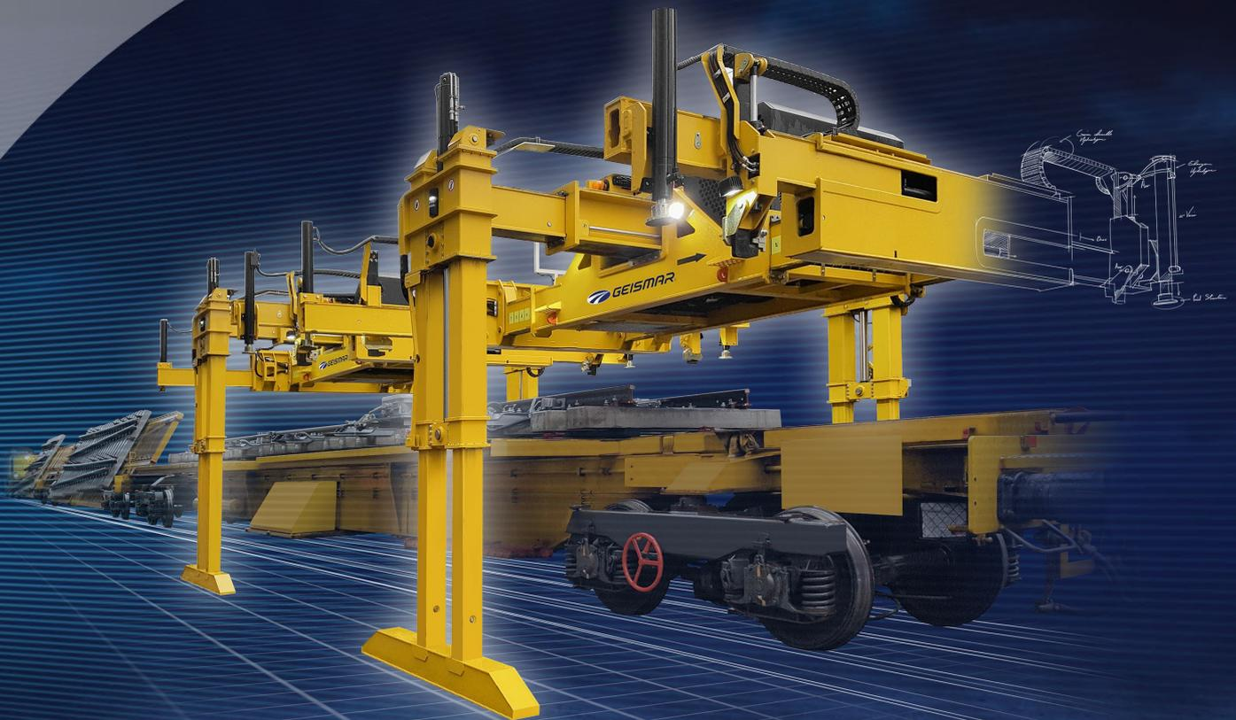
*Capable de poser tout type de voies et appareils de voie à partir d'un wagon pupitre*
