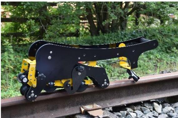
O trole pode ser facilmente dobrado e montado por apenas um operador, agilizando o serviço de inspeção assim que chegar na via.
